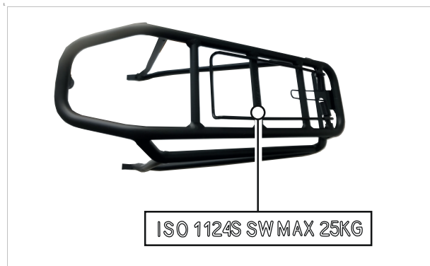
Abbildung 151: Auf dem Gepäckträger ist seine maximale Tragfähigkeit (1) ausgewiesen
