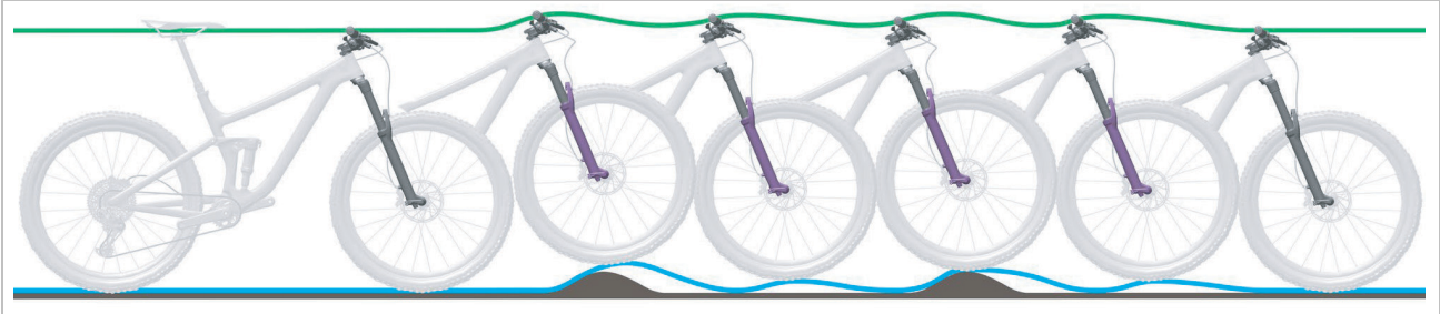
Abbildung 184: Zu schnelles Ausfedern der Federgabel
