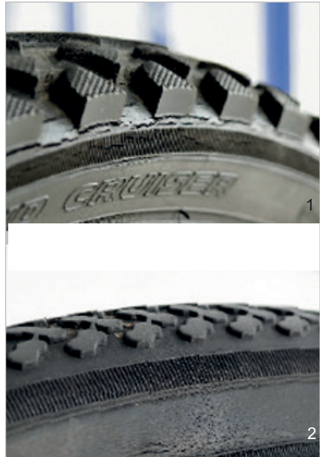
Abbildung 103: Beispiele für Ermüdungsrisse (1) und Alterungsrisse (2)
