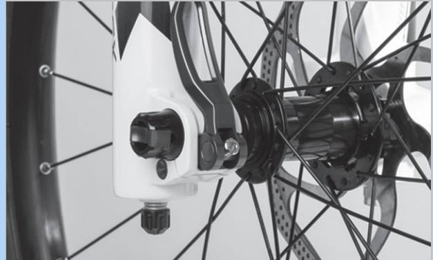
Abbildung 132: Spannkraft des Schnellspanners einstellen
