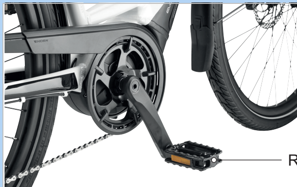
Abbildung 44: R-Pedal im rechten Kurbelarm
